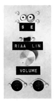
Ce préamplificateur peut également servir pour amplifier un magnétophone qui sort une tension comprise entre 50 et 200 mV. Dans ce cas, il ne faudra pas jouer sur le potentiomètre  $P_1$  (on saturerait  $T_2$ et  $T_3$ , de toute façon), mais il est nécessaire d'augmenter la valeur de  $R_9$ = 3,3 k $\Omega$ , pour diminuer le gain de l'ensemble.
